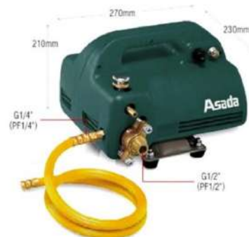
รูปที่ 3.29 ปัมมทดสอบความดันน้ำแบบเครื่องยนต์
