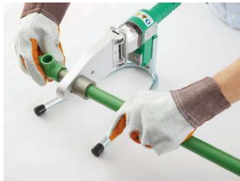
รูปที่ 4.22 แสดงการให้ความร้อนท่อและข้อต่อพีอีอาร์
