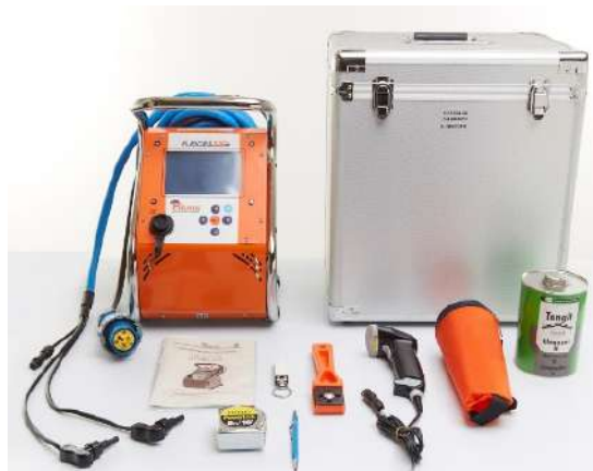
รูปที่ 4.24 แสดงเครื่องเชื่อม Electro Fusion (ที่มา : ท่อเอสซีจี)
