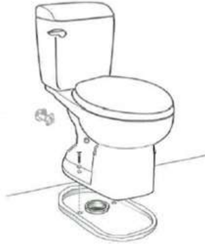
รูปที่ 4.41 ตัวอย่างทำเครื่องหมายแนวก่อปูนซีเมนต์ขาว และรูยึดโถส้วม
