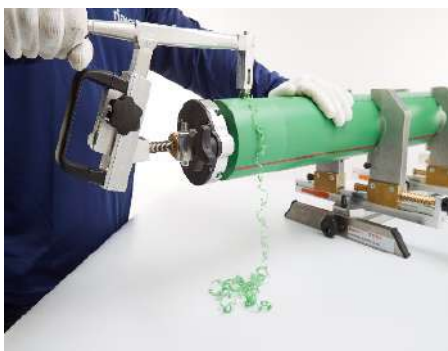
รูปที่ 4.26 แสดงการปอกผิวท่อ และเช็ดทำความสะอาดท่อและข้อต่อพีพีอาร์ (ที่มา : ท่อเอสซีจี)
